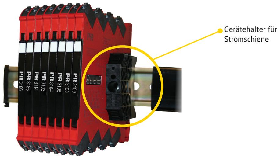
Der 3114 kann auf der Hutschiene oder der Power Rail installiert werden. Bei Marine-Anwendungen müssen die Geräte durch einen Gerätehalter für die Stromschiene gestützt werden (PR-Teilenummer 9404). Geräte zur Versorgung können nach Anwendungsbedarf auf der Power Rail installiert werden.
