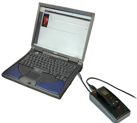
Nach Abschluss der Konfiguration des Geräts mit 4501 können die Parameter auf das PC-basierte PReset-Programm übertragen werden. Das mitgelieferte USB-Kabel stellt eine Verbindung zwischen ConfigMate 4590 und dem USB-Anschluss des Computers her. Der PC erfasst dann automatisch den benötigten Treiber über das Internet. Weitere Informationen zur Verwendung der PReset-Software finden Sie im Handbuch des PReset 5909.
